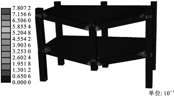
图 12 第 1 层 AB、BC 梁端下侧混凝土受拉损伤 Fig. 12 Concrete tensile damage at end of beam AB and BC 与数值模拟结果基本一致。
