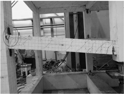
图 9 第 1 层 BC 梁 B 端下侧弯曲裂缝 Fig. 9 Flexural cracks at B end of beam 1-BC
