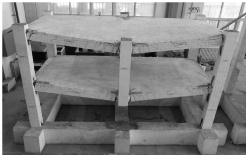
图 13 最终破坏形态
