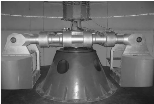
图 2 TLJ-3 土工离心机 Fig. 2 TLJ-3 geotechnical centrifuge
