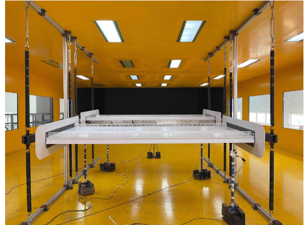
图 3 节段模型风洞试验布置
