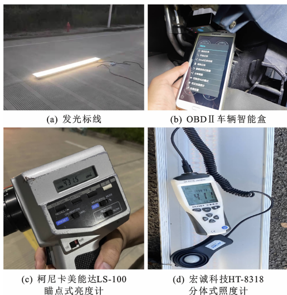
图1 实车试验相关设备
