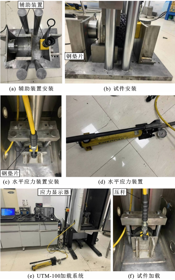
图2 压-直剪操作试验
