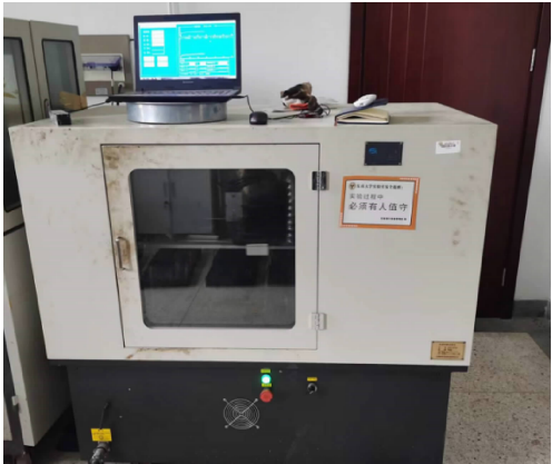
图 3 高温车辙试验 Fig. 3 High-temperature rutting test
