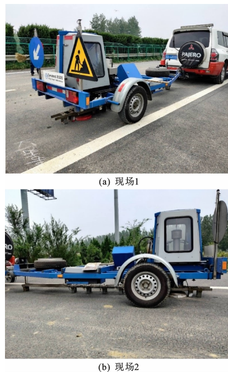
图 7 FWD 现场检测
