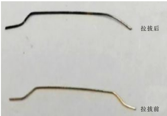
图 11 端钩形纤维拉拔前和拉拔后
