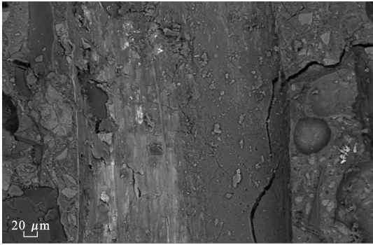
图 12 端钩形纤维拔出隧洞裂缝(放大 200 倍)
