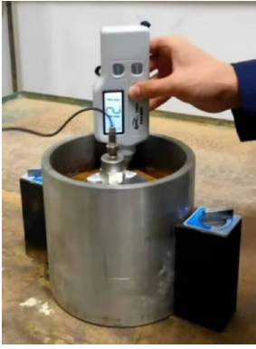
图2 试件系统位移峰-峰值或速度有效值测量
