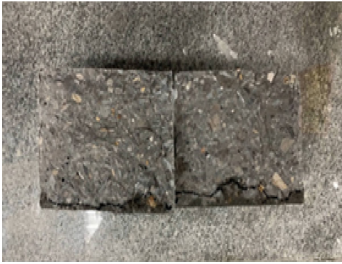
图4 混凝土抗水渗透试验试件
