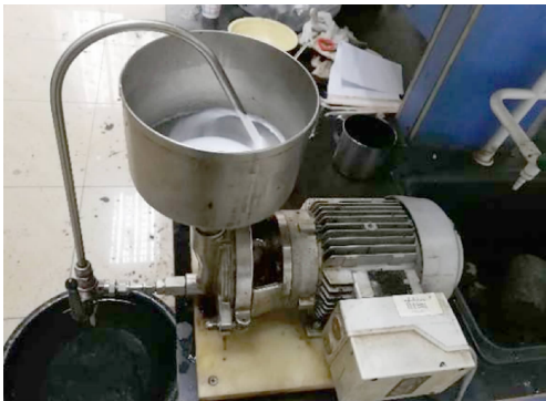
图 1 胶体磨 Fig. 1 Colloid mill
