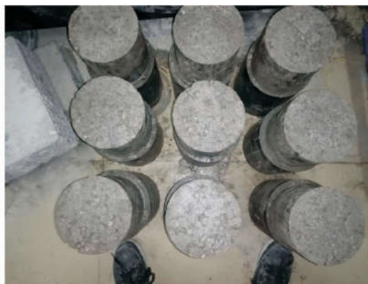
图 2 再生水稳碎石试件
