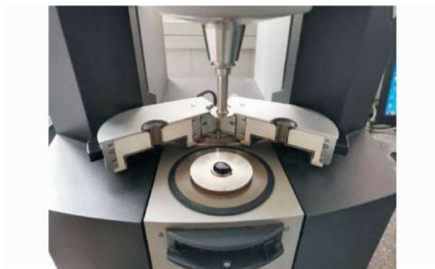
图 9 将浇筑好沥青胶浆试样的试验板装回流变仪
