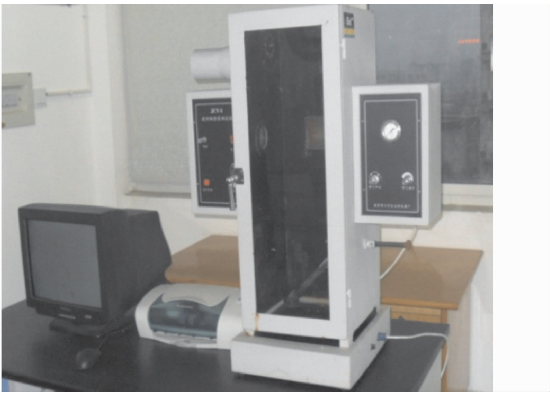
图2 DBDPE复合阻燃沥青烟密度等级试验
