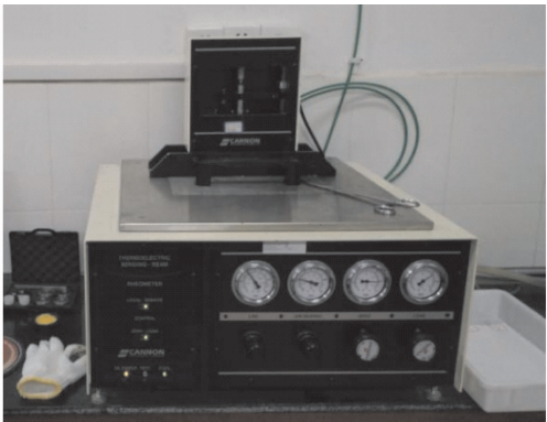
图4 DBDPE复合阻燃沥青弯曲梁流变试验
