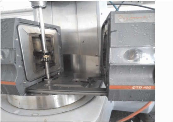
图3 DBDPE复合阻燃沥青动态剪切流变试验
