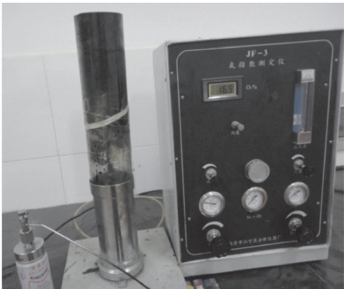
图 1 DBDPE 复合阻燃沥青极限氧指数试验
