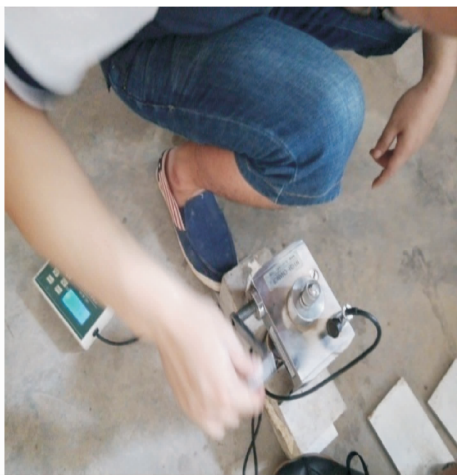
图 1 拉拔试验 Fig. 1 Pull-out test
