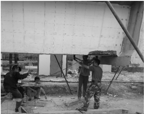
图 5 钢束应力测试
