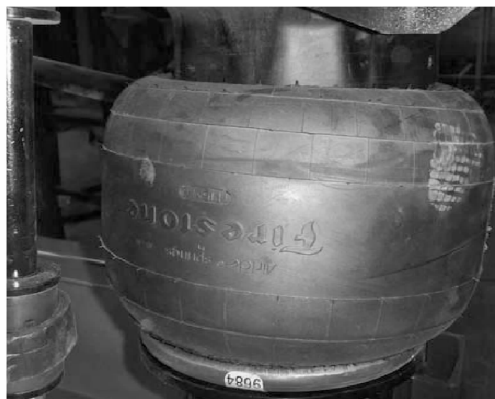
图 2 试验用空气悬架气囊
