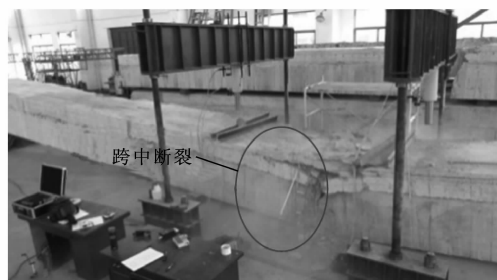
(b) 试验梁跨中断裂
