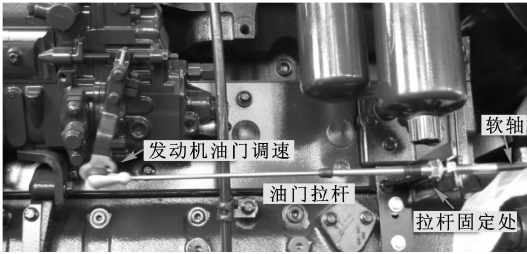
图3 油门电机与发动机调速器连接
