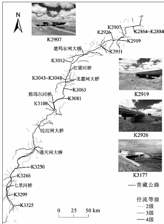
图 4 青藏公路多年冻土区径流分布 Fig.4 Runoff distributions along the QTH in permafrost regions
