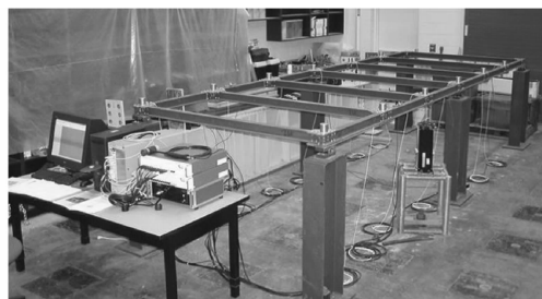
图 3 桥梁结构健康监测基准结构试验模型
