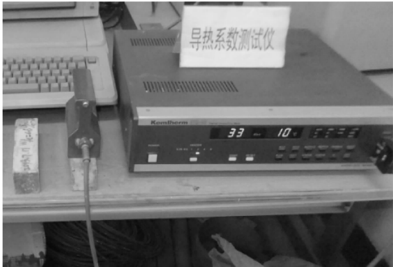
图 3 导热系数试验 Fig. 3 Thermal conductivity test
