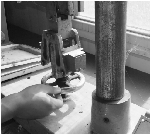
图 4 抗折强度试验 Fig. 4 Flexural strength test
