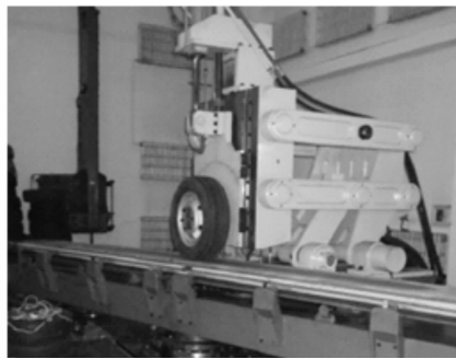
图 1 轮胎力学性能参数测试
