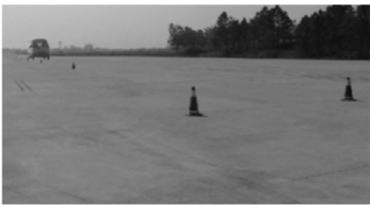
图 10 蛇行试验 Fig. 10 Pylon course slalom test
