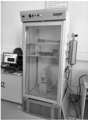
图 1 四点弯曲疲劳试验装置及温控箱
