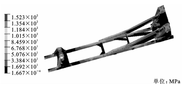
图 7 改进后满载弯曲工况的应力
