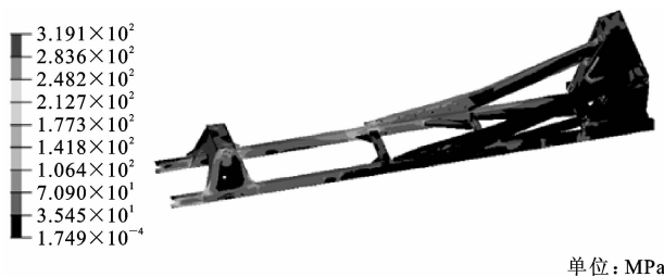
图 8 改进后双轮抬高极限扭转工况的应力
