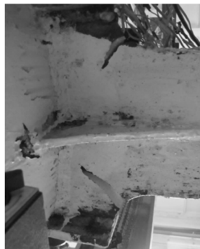
图 9 试件 SBJ2-1 加肋处钢管局部撕裂
