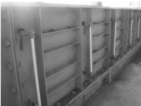
图 4 注浆模型中的观测管
