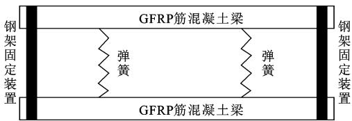
图 2 试件预裂持续荷载装置
