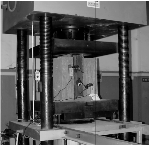
图5 试验机及位移计布置
