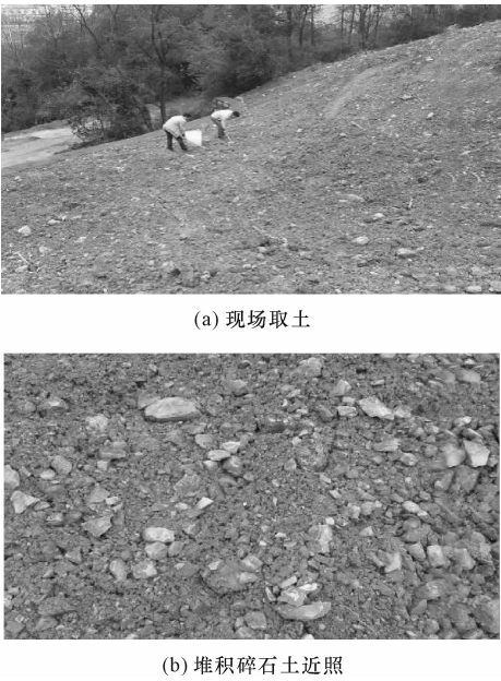
图 1 堆积碎石土现场照片 Fig. 1 Photo of eluvial gravel soil
