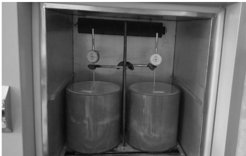
图 1 试验装置实物 Fig. 1 Expansion test device
