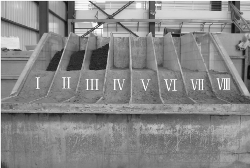
图 3 炭质泥岩-土分层路堤填筑过程
