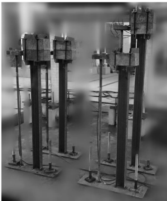
图 5 结构在振动台上布置 Fig. 5 Arangement of structure on shaking table
