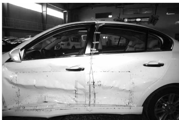
图6 HEV 侧面碰撞试验变形结果
