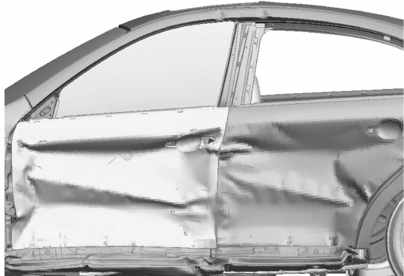
图 4 HEV 侧面碰撞侧面变形结果 Fig. 4 Side crash aberration of HEV bodywork
