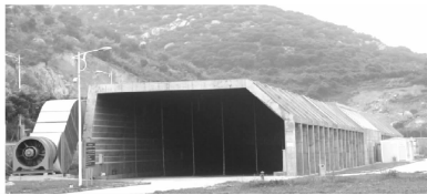
图 1 1:1 足尺沉管试验隧道
