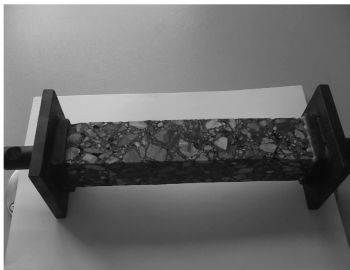
图 4 沥青混合料直接拉伸试验试件 Fig. 4 Asphalt mixture direct extension test specimen
