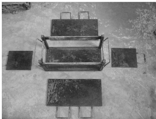
图1 模拟施工试验槽
