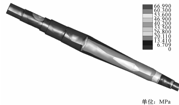
图 10 半轴 Von Mises 应力云图
