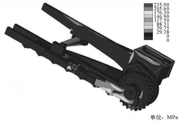
图 7 履带车辆总体 Von Mises 应力云图
