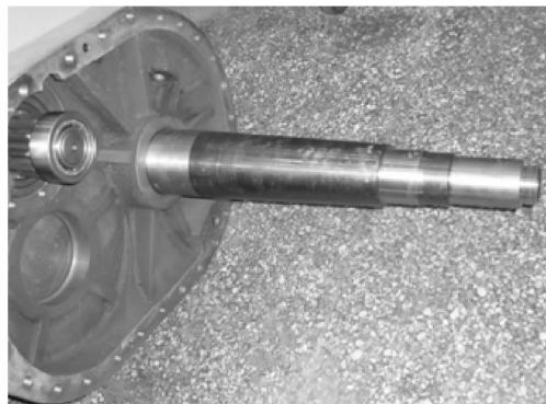
图 12 履带车辆改进后的终传动系统
