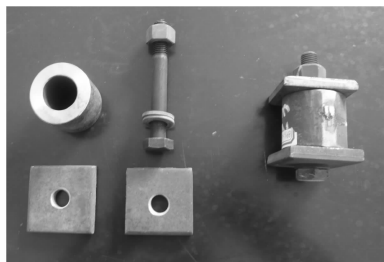
图2 螺杆轴力测试装置实物
