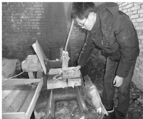
图 10 切割测量上、中面层压实度
