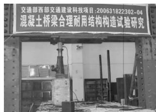
图1 静载试验加载装置
