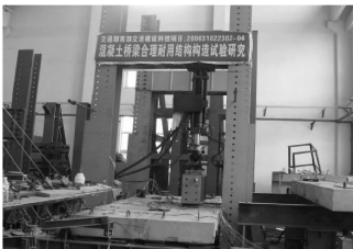
图 2 疲劳试验加载装置 Fig. 2 Loading device of fatigue test
