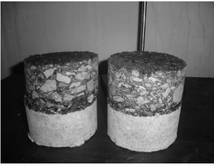
图 13 钻芯取样后的试件
