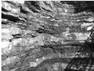
(b) ZK10+732 灰色~灰黑色、薄层~中层状中风化泥质粉砂岩、泥岩
