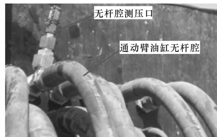
图 10 动臂油缸无杆腔测压口
