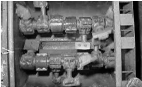
图 5 试验搅拌机的双轴搅拌叶片
