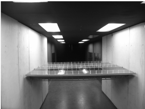
图 2 悬挂在风洞中的试验模型 Fig. 2 Two spring suspended models in wind tunnel
