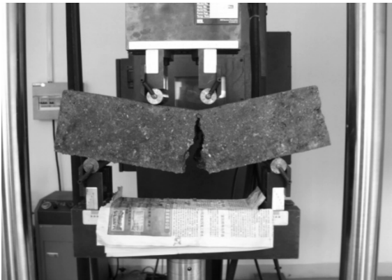
图 2 疲劳试验过程 Fig.2 Process of fatigue test
