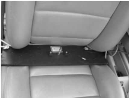
图 3 固定在车座椅的加速度传感器
