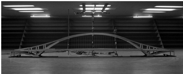
图 5 全桥气弹模型成桥状态(90°风偏角)
