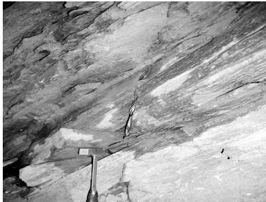
图5 后缘裂隙中的渗水
