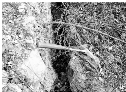
图2 地表的后缘拉张裂缝
